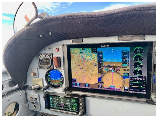
Figura 6 - Painel do T-27 após a modernização.
